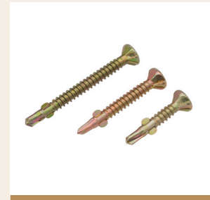
ברגי מאסטרקיר יצור בלעדי טאיואן ראש קודח + כנפיים לפלדה מעל עובי 0.7 מ"מ עד 1.6 מ"מ, אורך 25 מ"מ, 35 מ"מ, 45 מ"מ
