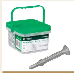
ברגי Hardiedrive מתוצרת ג'ימס הארדי ראש קודח + כנפיים לפלדה מעל עובי 0.7 מ"מ עד 1.6 מ"מ אורך 32 מ"מ, דרגת עמידות 4
